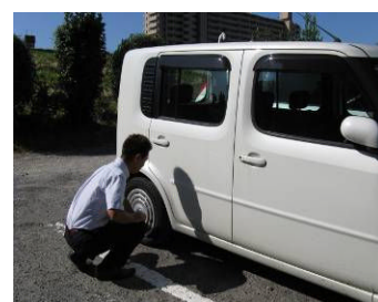
タイヤ空気圧の定期点検、補充
